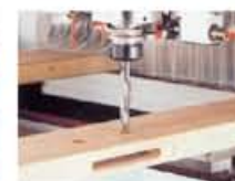
Пазование сбоку и сверление по пласти
